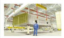
C'est à Nantes qu'est fabriqué le tronçon central. Cette partie très lourdement chargée est réalisée à 50% en fibre de carbone pour l'A380. Une telle réalisation permet un gain de poids d'une tonne et demi.
